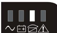
Желтый светодиодный индикатор Байпаса каждые 2 минуты издает звуковой сигнал. Светодиод загорается красным в момент сигнала предупреждения. ЖК-дисплей отображает параметры фактической нагрузки на ИБП и мощность аккумулятора.
