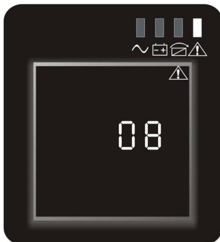
Режим сбоя (код ошибки отображен на интерфейсе ЖК-дисплея)
