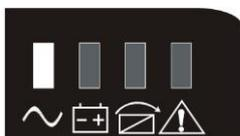
Когда входное напряжение переменного тока осуществляется в рабочем режиме согласно с правилами работы, то ИБП работает в режиме двойного преобразования энергии.
