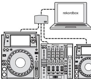
Подключите компьютер и DJ проигрыватель.
