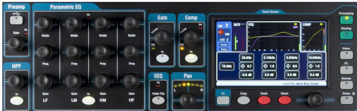
**Mono input CH1-16** = источник Source, предусилитель Preamp, фильтр отсечки НЧ HPF, гейт Gate, параметрический эквалайзер PEQ, компрессор Compressor, задержка Delay, стерео объединение Stereo linking
