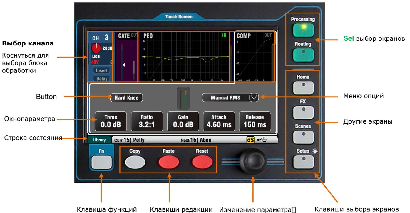
**Кнопка** – коснитесь для выбора ее функции или изменения ее статуса. В целях защиты от случайного нажатия, некоторых кнопок нужно касаться не менее 1 секунды, например, для включения фантомного питания. Они помечены как '(Hold)'.
