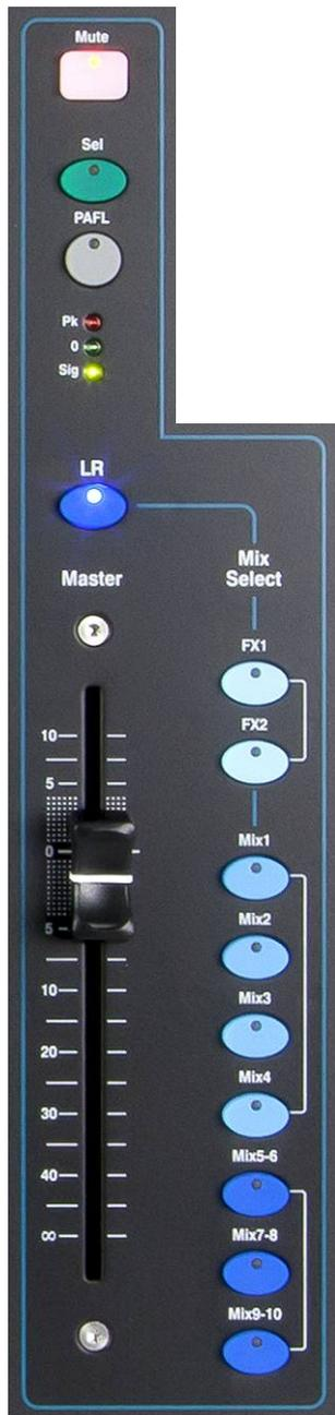
Qi имеет отдельную полосу фейдера для мастеров микса, в которой представлен фейдер и элементы управления для текущего микса, выбранного с помощью кнопки **Mix**. Посылы на выбранный микс представлены на 16 фейдерах, которые перемещаются, чтобы показать текущие настройки. Это обеспечивает быстрый доступ к каждому миксу без необходимости переключения к слою мастеров.
