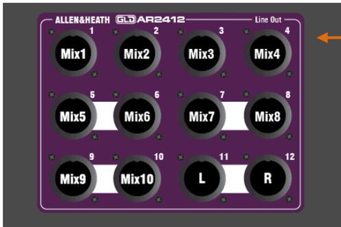
Все 10 миксов и основной выход LR могут быть подключены здесь для отправки на FOH PA и мониторные усилители и послы на сцене.
