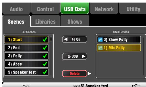
Индивидуальные сцены могут передаваться между микшерами Qu через устройства USB, подключенные к порту Qu-Drive. Это обеспечивает быстрый способ передачи параметров без перезаписи текущих сцен и предпочтений.
