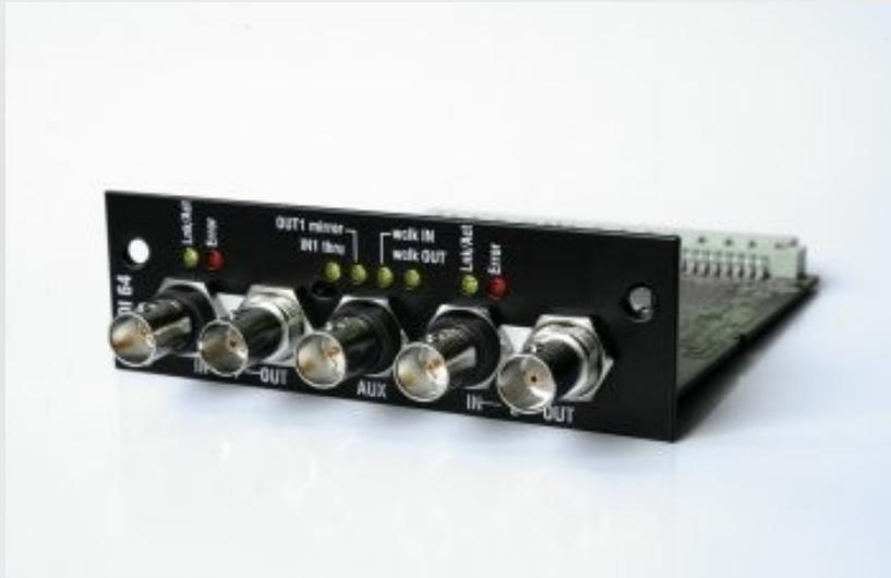
Поддержка сетевого протокола MADI позволяет подключать внешние интерфейсы (например, RME HDSP MADI), конвертеры, дополнительные сценические рэки iLive и iLive-T, консоли iLive и другие устройства, работающие по MADI. Поддерживается горячее резервирование.
