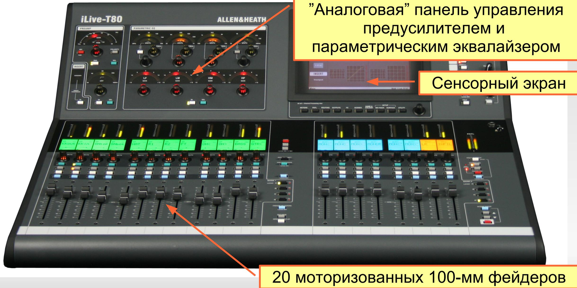
"Аналоговая" панель управления предусилителем и параметрическим эквалайзером
