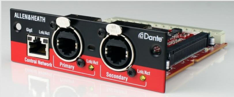
**NEW** Сетевой интерфейс Dante позволяет подключать любые внешние устройства, поддерживающие стандарт Dante или AVB (Audio and Video Broadcasting). В комплект поставки входит драйвер Virtual Soundcard, включающий поддержку ASIO, позволяющий без использования дополнительного оборудования организовать многоканальную звукозапись/воспроизведение.
