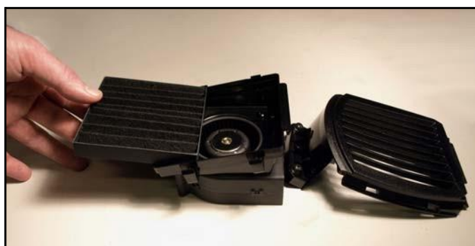
Рисунок 17: Выравнивание воздушного фильтра головной части
